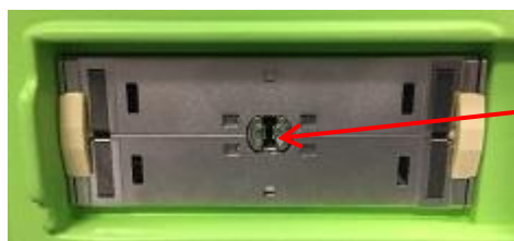
Rysunek 20: Wycięcie blokujące w gnieździe złącza przetwornika
